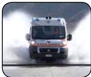
Il fenomeno dell'aquaplaning si verifica quando gli pneumatici non riescono a spostare in modo adeguato lo strato d'acqua che ricopre l'asfalto, portando le gomme a galleggiare, con conseguente perdita di aderenza.
